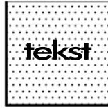
Hatch: Dots Pen : 0.35 Skala : 20
