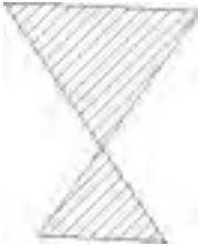
Ill. 2. Når der optegnes arealer må linierne ikke krydse hinanden. Arealet vil blive beregnet forkert.
